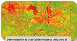
Determinación de vegetación existente utilizando el Índice Normalizado de Vegetación (NDVI) a partir de la imagen NIR del UAV (más verde=mayor vegetación).
